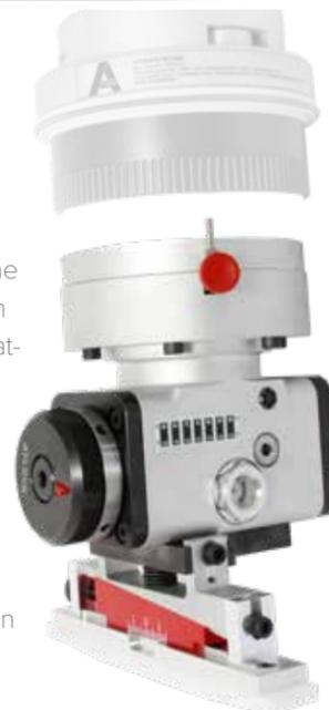
Mit den Tastaggregaten von ATEMAG, die in die Spindel der CNC eingespannt werden, können durchgehende Nuten in Werkstücke eingebracht werden, indem ein Nutsägeblatt eingespannt wird. Wenn das zu bearbeitende Material Unebenheiten aufweist, können diese durch das Tastmittel des Aggregats ausgeglichen werden, und somit eine gleichbleibende Nuttiefe gewährleisten.
