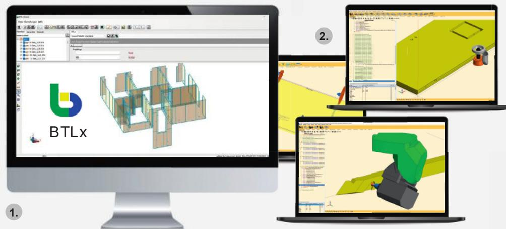
1. BTLx-Import für NC-HOPS® ermöglicht **vollautomatische Übernahme** von Teilen aus CAD Programmen.
